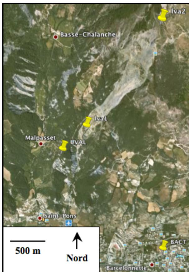
**Figure 5 : Localisation des stations GPS sur le glissement de terrain de la Valette.** La ligne de base BACT-LVAL est de l'ordre de 1950 m, 2050 m environ séparent BACT de lva1 alors que BACT et lva2 sont distantes d'environ 3130m. Pour les lignes de base du glissement à proprement parler LVAL-lva1 est de l'ordre de 450m et LVAL-lva2 et lva1-lva2 valent respectivement 2240m et 1810m environ (fond de carte Google Earth).
