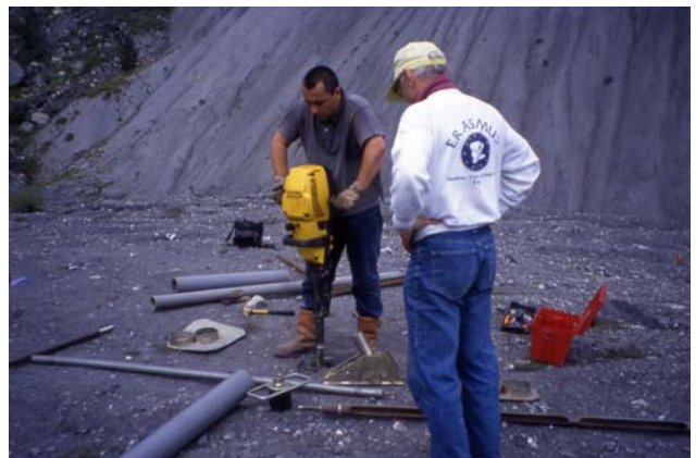
Photo 5.14 : Vibropercuteur à gouges sur le replat E (mai 1997).
