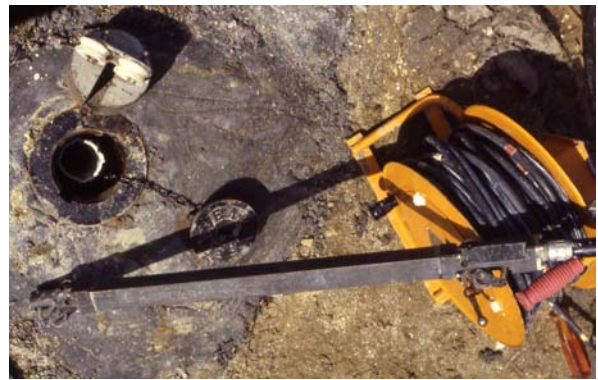
Photo 5.12 : Sonde inclinométrique et tube rainuré en place dans un forage.
