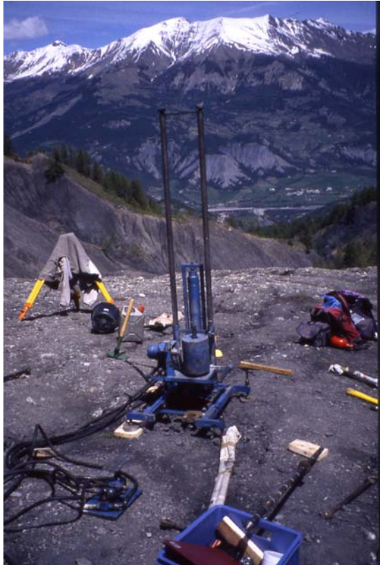
Photo 5.17 : Pénétrömètre dynamique lourd DL 30 et accessoires. Vue vers le Nord sur l'adroit de Faucon de Barcelonnette (juillet 1996).
