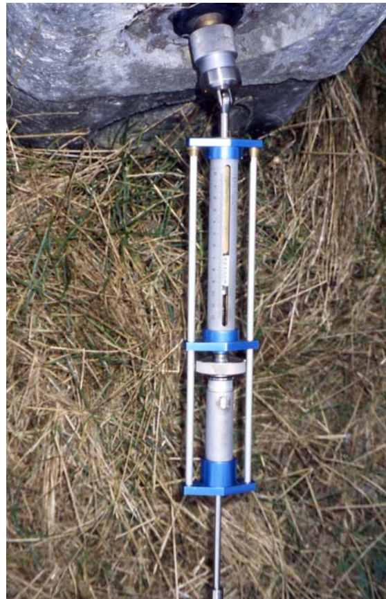
Photo 4.2 : Fissuromètre : système de mesure de précision à vis micrométrique de l'allongement de la base de mesure.
