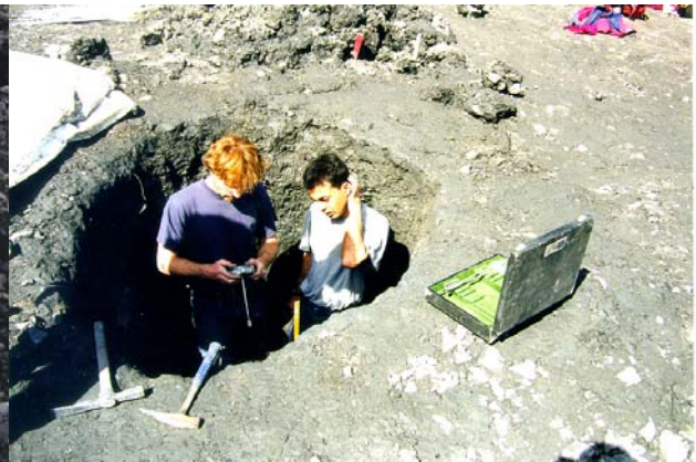
Photo 5.16 : Essais au scissomètre dans une fosse manuelle sur le replat E (Cliché : Malet, mai 1999).
