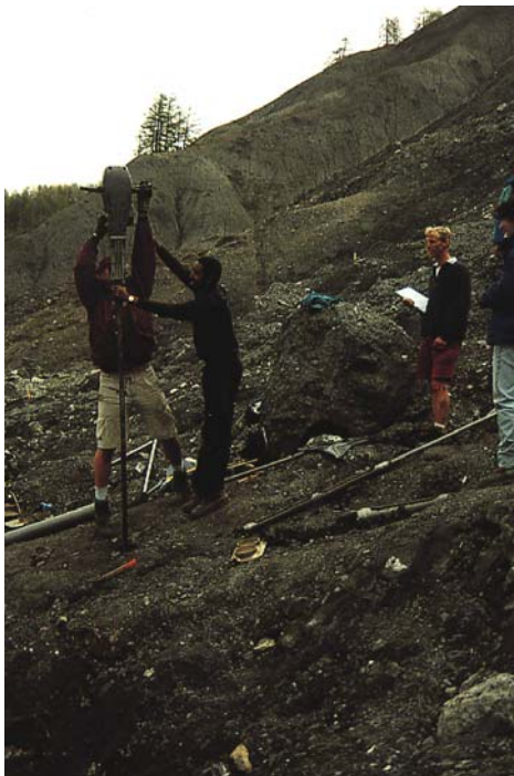
Photo 5.13 : Vibropercuteur à gouges sur le profil B (Cliché : Malet, mai 1998).
