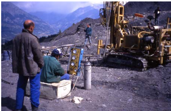
Photo 5.11 : Essai préssiométrique : contrôleur pression-volume et foreuse Nuzi (juillet 1996)
