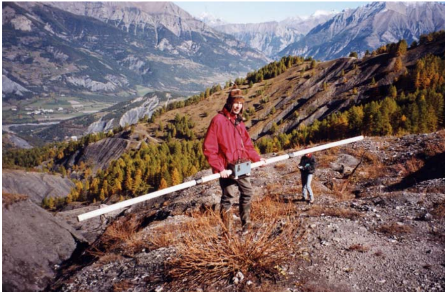
Photo 6.1 : Prospection Slingram avec un appareil EM 31 sur la coulée de Super-Sauze, octobre 1998.
