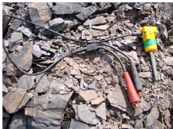
*Photo 4.9 : Géophone utilisé pour la prospection sismique*
