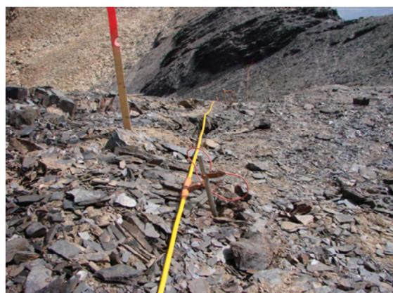
*Photo 4.8 : ligne d'électrodes raccordées à une flûte*
