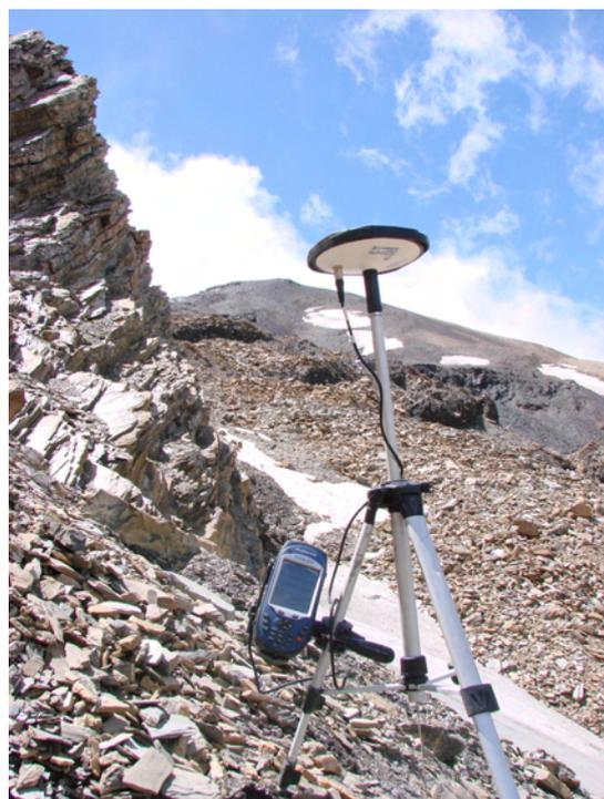
*Photo 4.2 : mesure d'un bloc marqué au moyen du récepteur mobile, Vallon du Bérard*
