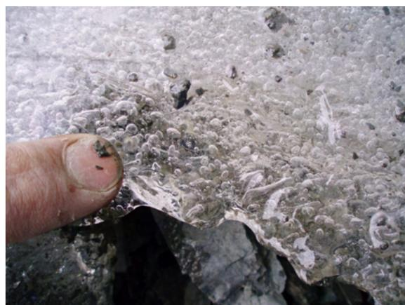
Photo 5.5 : bulles d'air dans un des blocs de glace pure prélevé.
