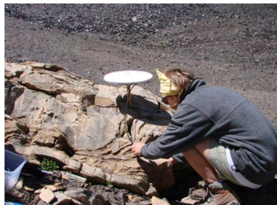
Photo 4.4 : l'antenne Zéphir installée sur un bloc au moyen d'un spit.
