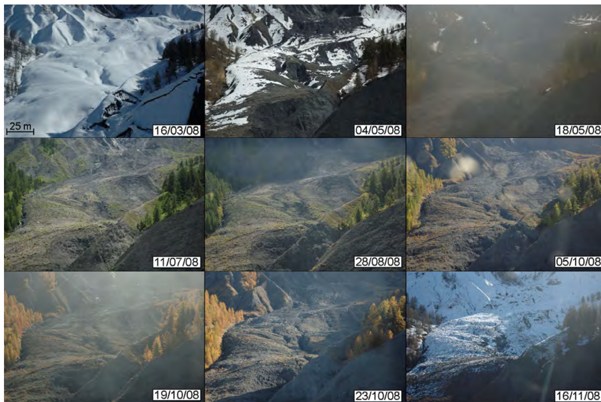
Figure 5.10 – Exemples de photographies de la coulée de Super-Sauze acquises par le système d'acquisition automatique en 2008 sous différentes illuminations et états de surface liés aux conditions météo-climatiques de la région. 16/03/08 – 04/05/08 – 16/11/08 : couverture neigeuse totale ou partielle (images non exploitables). 18/05/08 : précipitations et brouillard (image non exploitable). 11/07/08 : illumination homogène et image contrastée (image exploitable, conditions optimales pour la corrélation). 28/08/08 : ombrage fort dû à une couverture nuageuse partielle (image partiellement exploitable). 05/10/08 : salissures sur la vitre de la cabane (image partiellement exploitable). 19/10/08 : acquisition en contre-jour (image partiellement exploitable). 23/10/08 : contrastes d'illumination importants, ombrage fort (image partiellement exploitable).
