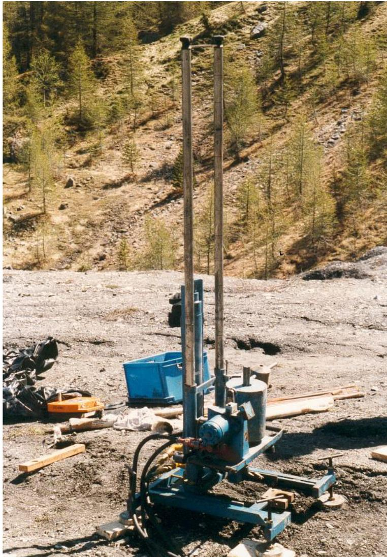
*Photo 9 : pénétromètre dynamique lourd installé sur la coulée*
