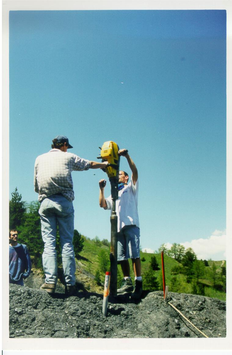
*Photo 1: exemple de sondage au vibro-percuteur*
