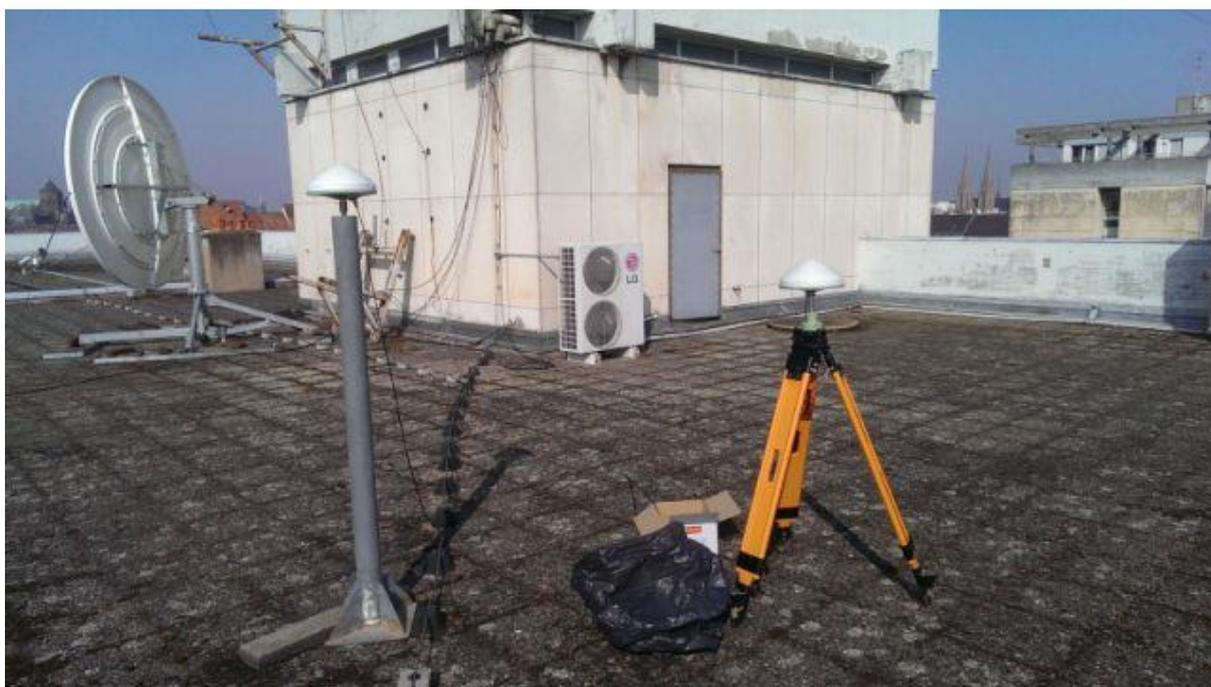
Figure 33 : deux récepteurs NOVATEL connectés à des antennes LEICA AR 10 et installés sur le toit de l'EOST.
