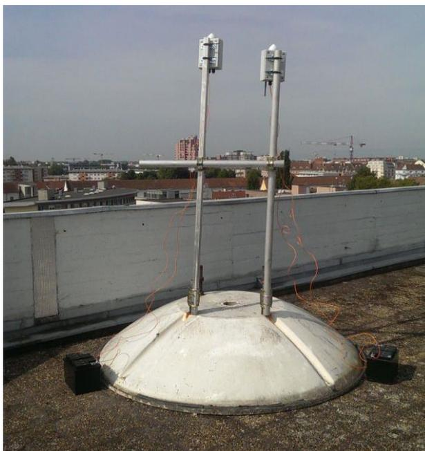
Figure 27: vue du système de fixation provisoire de deux récepteurs mono-fréquence GEOMON sur le toit de l'EOST.
