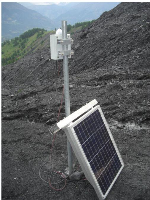
Figure 28 : Un GEOMON sur le glissement de terrain de Super-Sauze, connecté à une batterie et à un panneau solaire.
