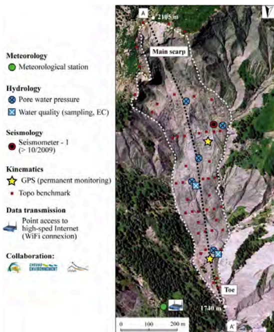
Figure 4.7 : Positions des stations GPS permanentes de la zone de glissement de La Super-Sauze selon l'OMIV [2014]
