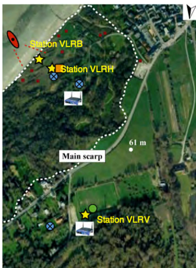
Figure 3.2 : Position des stations GPS de surveillance du glissement de Villerville (VLRV, VLRB, VLRH) selon l'OMIV [2014]
