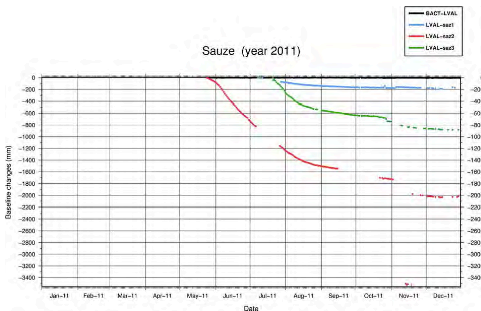
Figure 4.8 : Evolution des lignes de base entre les stations de Super-Sauze en 2011 selon l'OMIV [2014] - ( http://omiv2.u-strasbg.fr/gps/data/sauz/baseline_1x12_2011.jpg )
