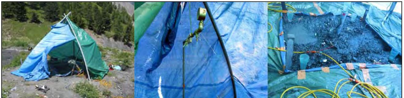
Figure 13 : Dispositif de la l'expérimentation : abri de la zone d'infiltration, simulateur de pluie, délimitation de la zone avec électrodes et piézomètres
