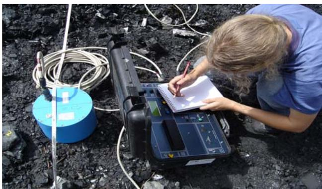
Illustration 29 Capteur sismique et centrale *City Shark II*
