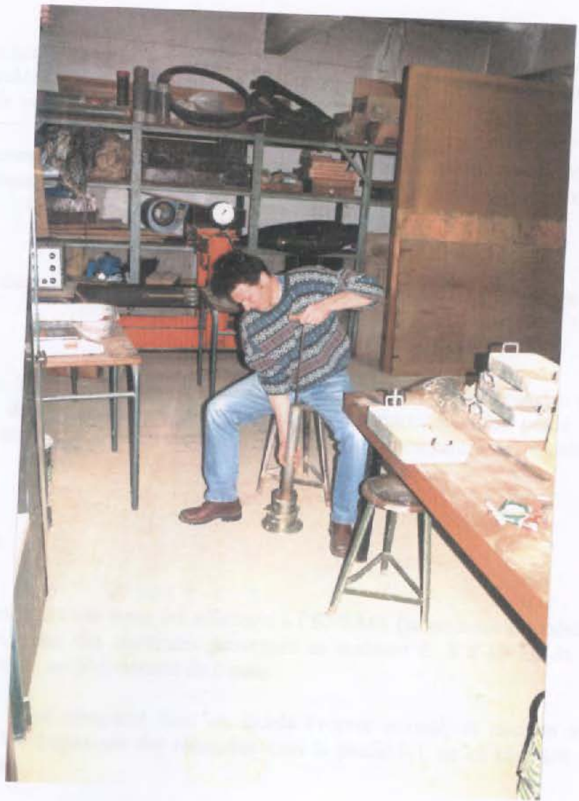
Photo 23 : Démonstration de l'essai Proctor normal.
