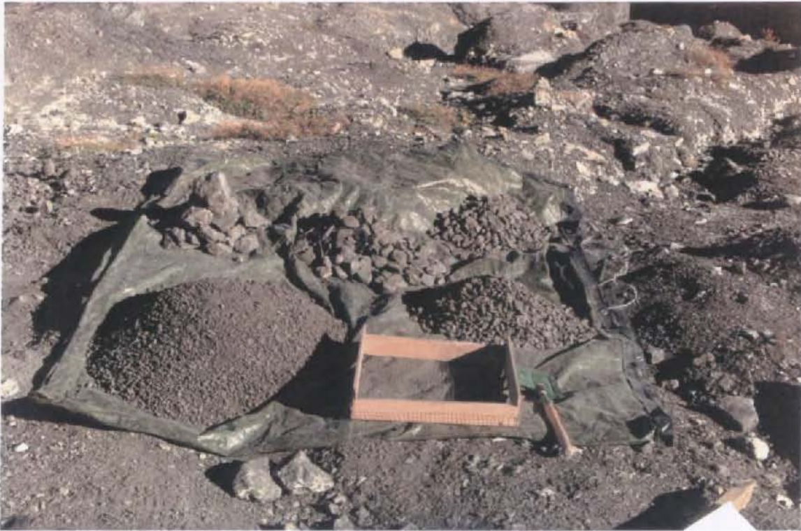
Photo 21 : Les différentes classes granulométriques déterminées sur le terrain.
