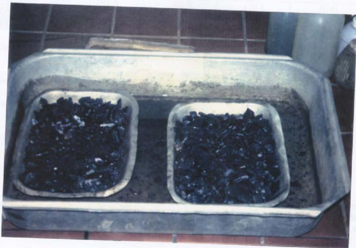
Photo 19 : Immersion des débris lors de l'essai de dégradabilité.
