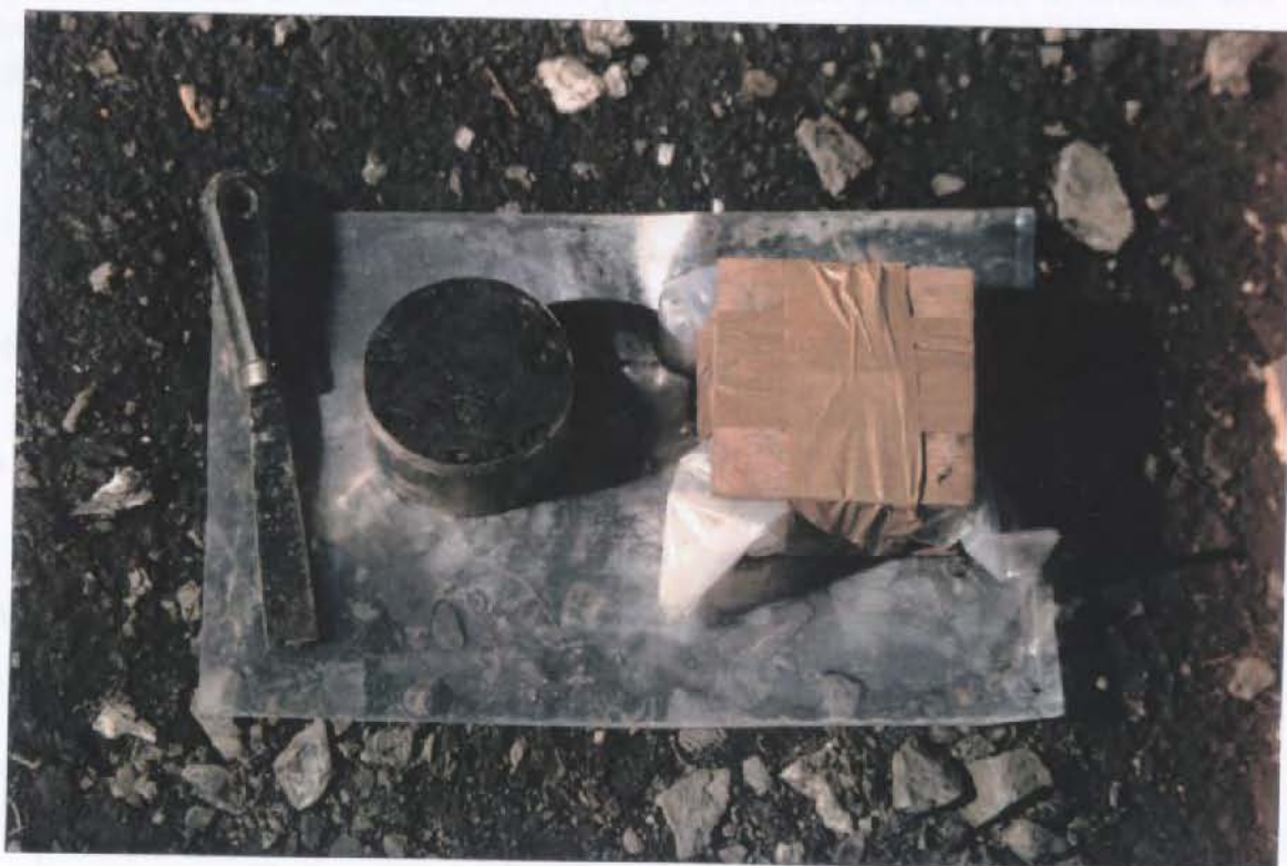
Photo 7 : Emballage des échantillons prélevés dans des carottiers métalliques.
