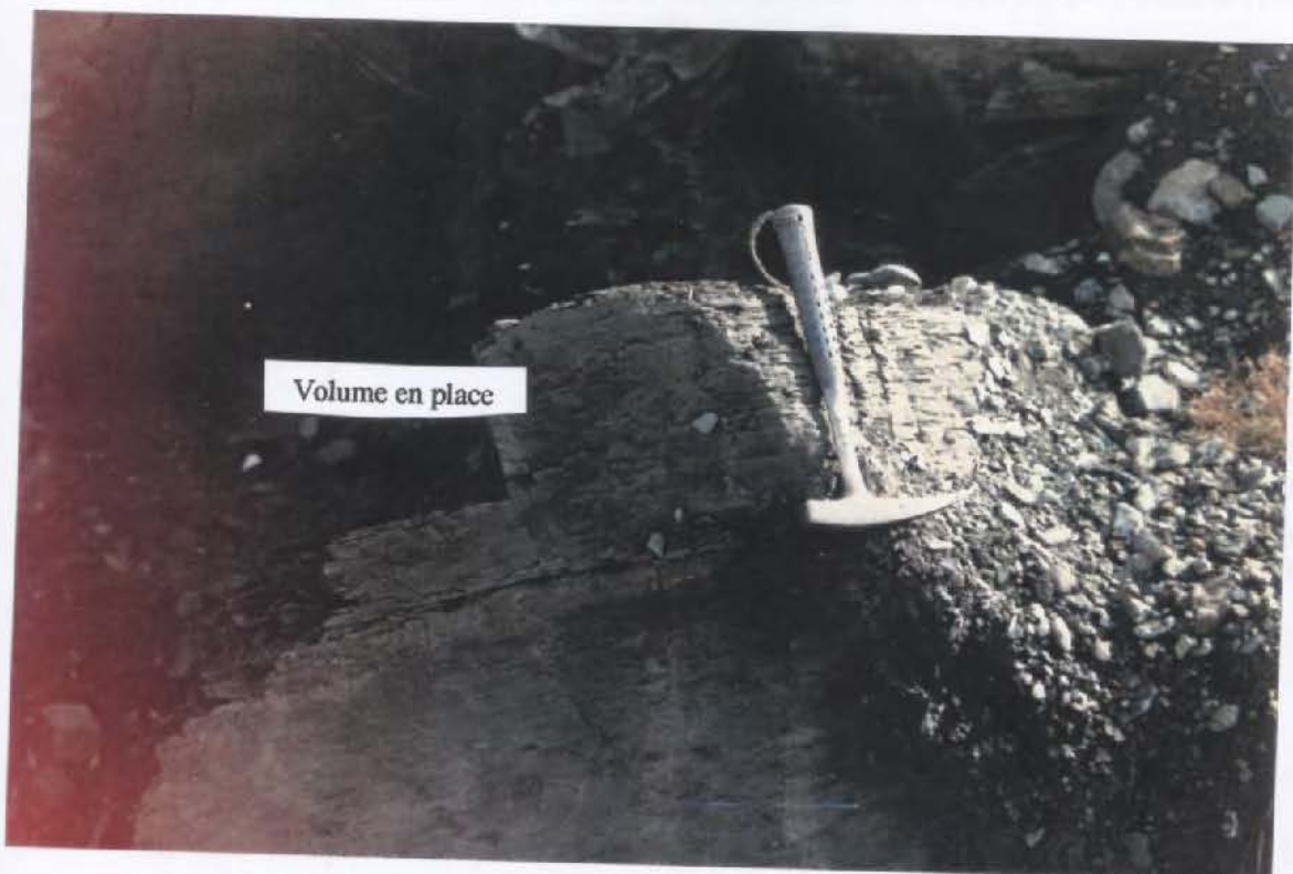
Photo 14 : Bloc 1 sur lequel un volume a été déterminé pour le calcul du coefficient de foisonnement.
