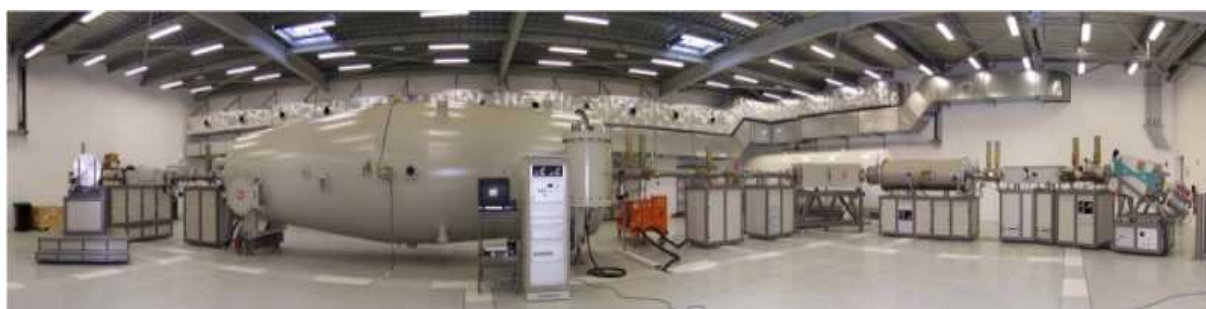
Fig. 8-6: Photographie du spectromètre de masse par accélération (AMS) utilisé au CEREGE ( http://www.cerege.fr ).
