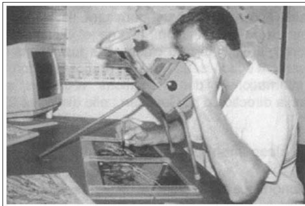
Figure I.6 : Photo-interprétation à l'aide d'un stéréoscope à miroir.
