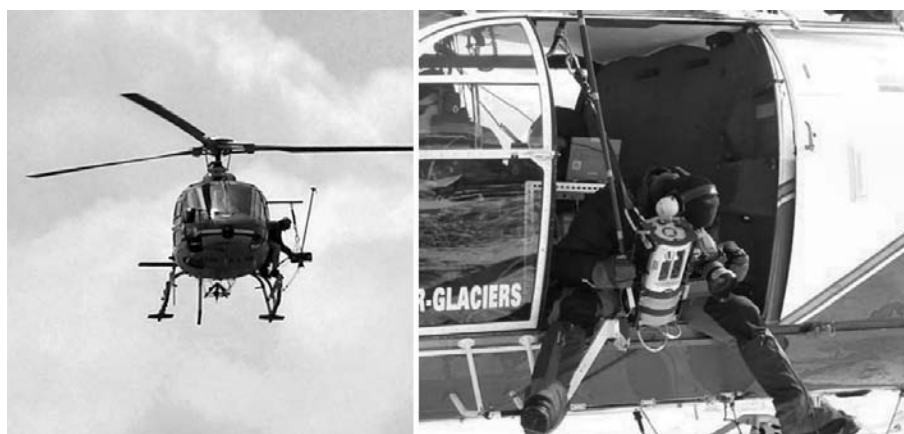
Figure IV.39 : Utilisation du système Helimap ® en vertical (à gauche) et en oblique (à droite), (d'après Vallet, 2007)
