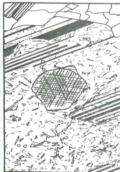
Figure 28 : Ech. A1560. Fines aiguilles de rutile maclées sagénite en épitaxie sur une biotite incluse dans un plagioclase séricitisé.
