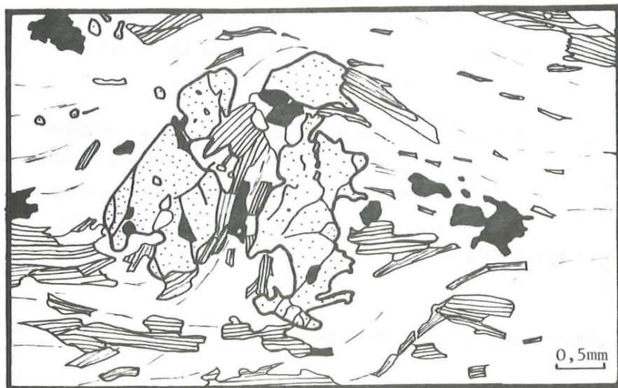
Figure 75 : Micrographie de biotite et grenat fossilisant un micro-pli L.m. A3910
