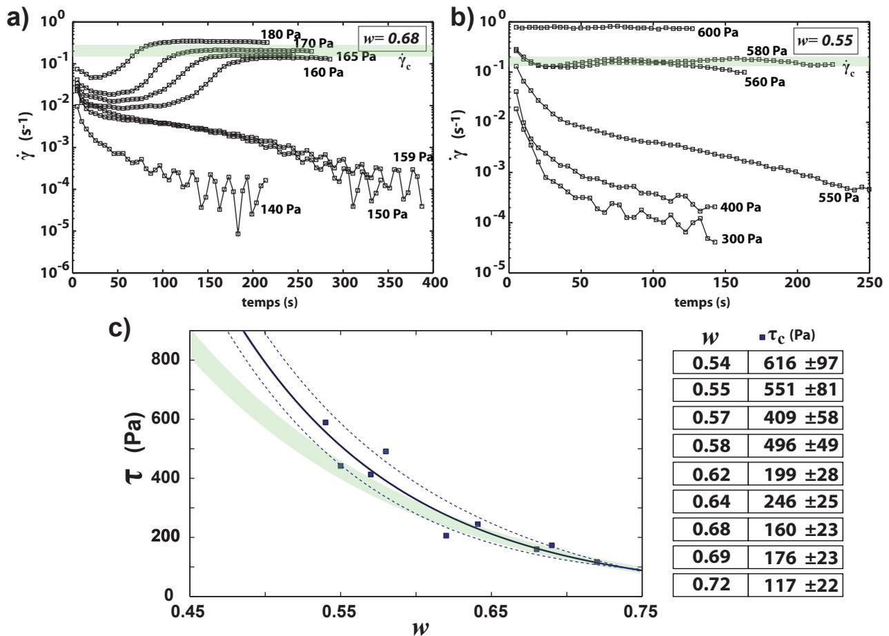
FIGURE 4.8 – Tests de fluage pour deux échantillons d'argiles à teneur en eau a) de  $w = 0,68$  (7 tests entre 140 et 180 Pa) et b)  $w = 0,55$  (6 tests entre 300 et 600 Pa). c) Courbes et tableau des valeurs des résultats obtenus pour tous les tests de fluage réalisés sur neuf échantillons d'argiles à teneurs en eau différentes. Modélisation des données par une loi exponentielle (le tracé vert représente l'estimation de la fonction obtenue à partir des courbes d'écoulement (figure 4.7b)).
