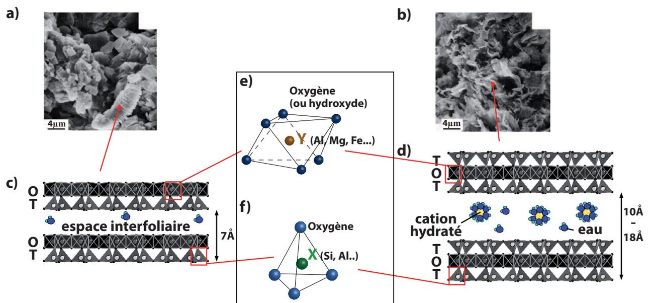
FIGURE 1.2 – a) Images MET (Microscopie Electronique en Transmission) d'une kaolinite et b) d'une smectite de Sasso (Italie) (*Lombardi et al. (1987)*). c) Représentatif schématique de la structure de Kaolinite et d) d'une montmorillonite (smectite) (modifié d'après *Bradbury and Baeyens (2002)*). Zoom sur un tétraèdre silicium-oxygène et sur un octaèdre aluminium-oxygène.
