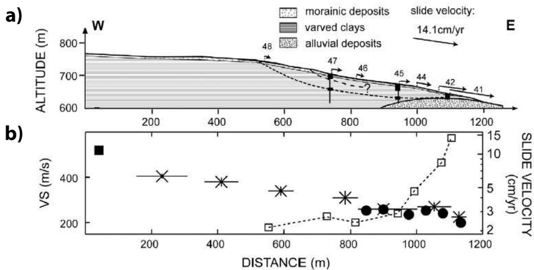
FIGURE 3.6 – a) Profil géotechnique du glissement d’Avignonet, les flèches représentent la vitesse du glissement en surface. b) Valeur des vitesses des ondes S à 5m de profondeur (carré : mesure par forage, croix : mesures par inversion des ondes de surface, ronds : mesures par réfraction des ondes SH). Les mesures des déplacements en surface sont également représentées (carrés vides) (Jongmans *et al.* (2009)).
