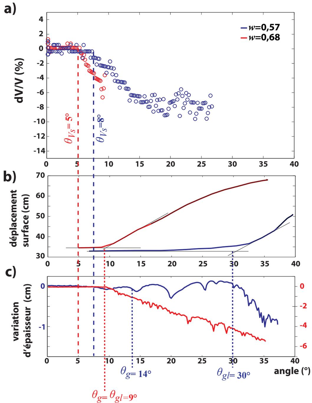
FIGURE 5.12 – Figure de conclusion de essais de plan incliné pour deux teneurs en eau (en bleu pour  $w = 0,57$  et en rouge pour  $w = 0,68$ ). a) Variations des vitesses relatives des ondes S. b) Déplacements des traceurs superficiels interpolés. c) Variations de l'épaisseur de la masse argileuse mesurées par le capteur de hauteur central (B).
