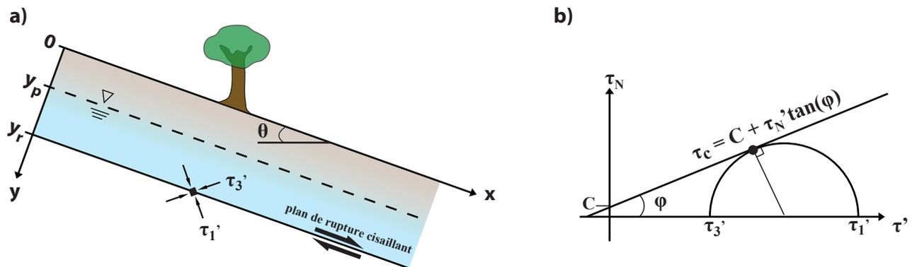
FIGURE 2.4 – Représentation schématique des paramètres du Facteur de Sécurité (équation 2.2). a) Profil schématique et définition des paramètres géométriques pour une pente infinie avec une nappe (*Iverson and Reid (1992)*). b) Cercle de Mohr-Coulomb et paramètres de contrainte associés.
