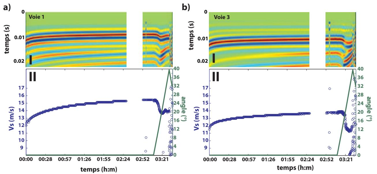
FIGURE 5.8 – Variation de  $V_s$  au sein de la masse argileuse au repos. a) et b) (I) toutes les corrélations enregistrées, (II)  $V_s$  et inclinaison du plan incliné pour les voies n°1 et n°2, respectivement. Le manque de données entre 2h30 et 2h50 est dû à l’arrêt impromptu de l’amplificateur de forme d’onde.
