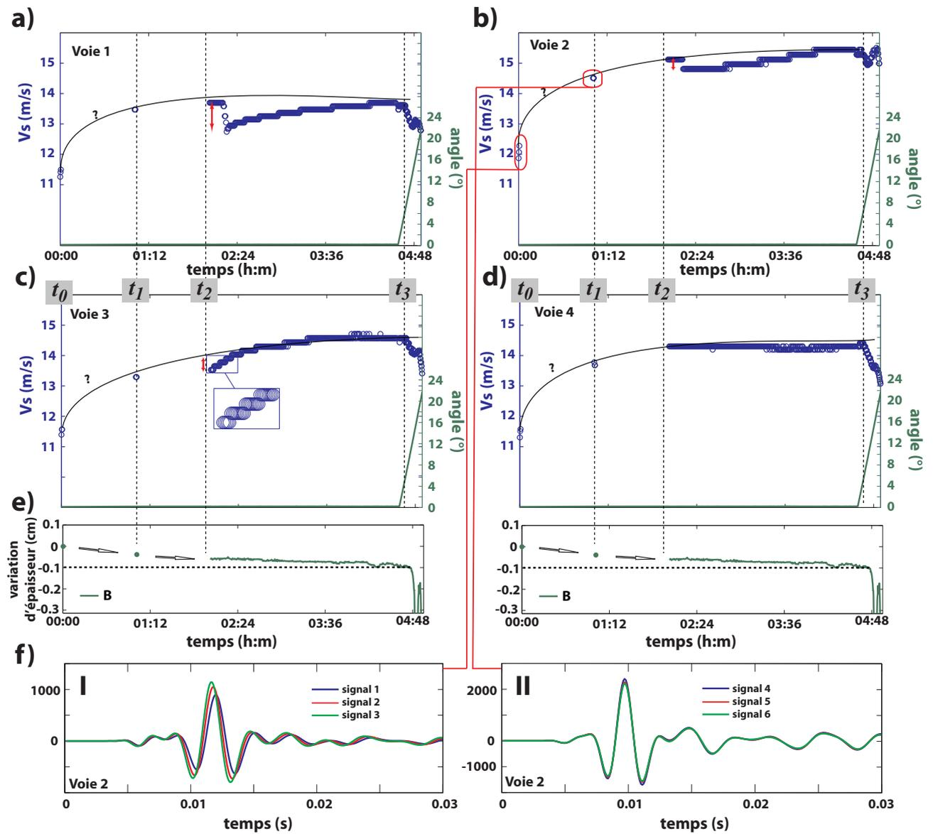
FIGURE 5.13 – Variations de  $V_s$  d’une masse argileuse au repos ( $w = 0,58$ ). Toutes les corrélations et vitesses des ondes S (et valeur de l’inclinaison de la pente) pour a) la voie n°1, b) la voie n°2, c) la voie n°3 et d) la voie n°4. e) Variations d’épaisseur du capteur de hauteur B. f) Corrélations (I) des 3 premiers signaux au temps  $t_0$  et (II) des 3 signaux suivants à  $t_1 = 1h$ , de la voie n°2.
