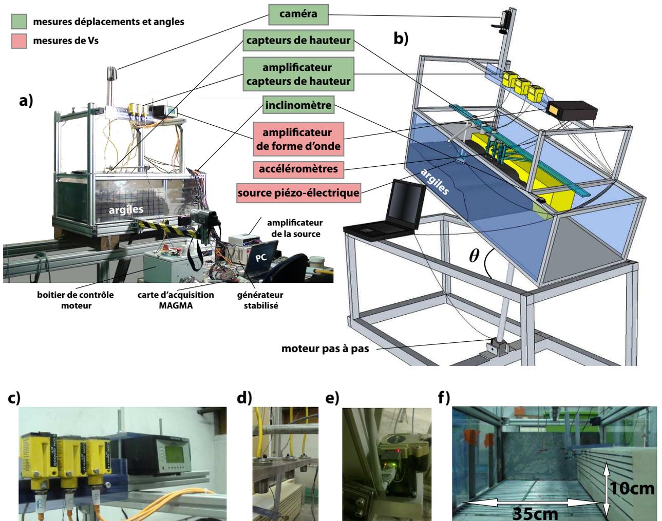
FIGURE 5.1 – Appareillage du plan incliné. a) Photographie générale du plan à l'horizontale et b) schéma du plan incliné et de ses appareils de mesures. c) Amplificateurs des capteurs de hauteur et amplificateur de forme d'ondes des signaux accélérométriques. d) Capteurs ultrasoniques de hauteur. e) Moteur pas à pas MDrive23. f) Vue de l'aval du plan incliné et dimensions du glissement.
