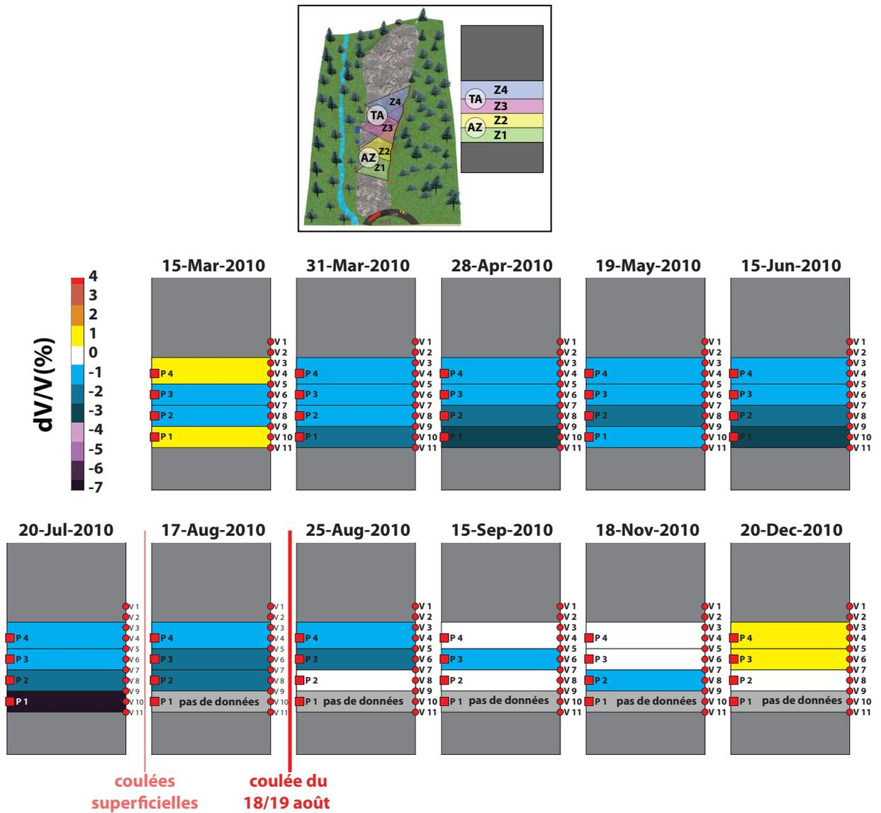
FIGURE 8.6 – Zonage et moyenne des variations de vitesses (12 Hz) suivant quatre zones du glissements (Z1 à Z4). Z1 et Z2 correspond à la zone de Transport (TA) et Z3, Z4 à la zone d'Accumulation (AZ). En encadré : le plan du zonage sur le glissement et la représentation schématique correspondante.
