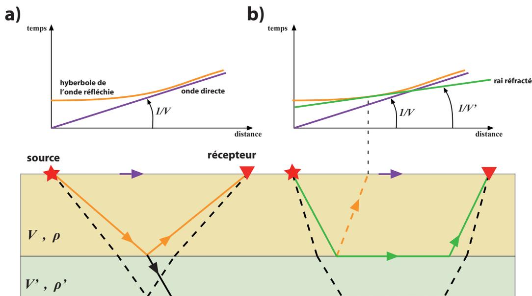
FIGURE 3.1 – a) Principe de la sismique réflexion et b) réfraction, pour deux strates de densités  $\rho$  et  $\rho'$  différentes définies par les vitesses  $V$  et  $V'$  respectivement. En bas : schéma de la propagation des premières arrivées. En haut : hodochrone correspondant.
