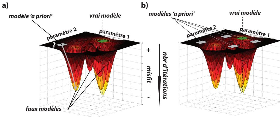
FIGURE 3.4 – Vue conceptuelle de la non unicité de l'inversion pour un modèle à 2 paramètres en fonction du nombre d'itérations du calcul du *misfit*. a) La méthode linéaire tend à faire converger le modèle a priori vers un faux modèle si les paramètres sont mal choisis. b) Méthode type Monte Carlo où plusieurs modèles initiaux sont définis, la probabilité de converger vers le bon modèle est plus importante.
