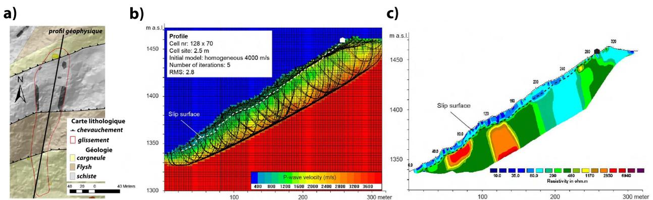
FIGURE 6.4 – Etudes géophysiques du glissement du Pont-Bourquin (*Brönnimann (2011)*). a) Carte lithologique de la zone du glissement-coulée de Pont-Bourquin. Profils géophysiques : b) Tomographie de sismique réfraction en ondes P. c) Tomographies électriques.
