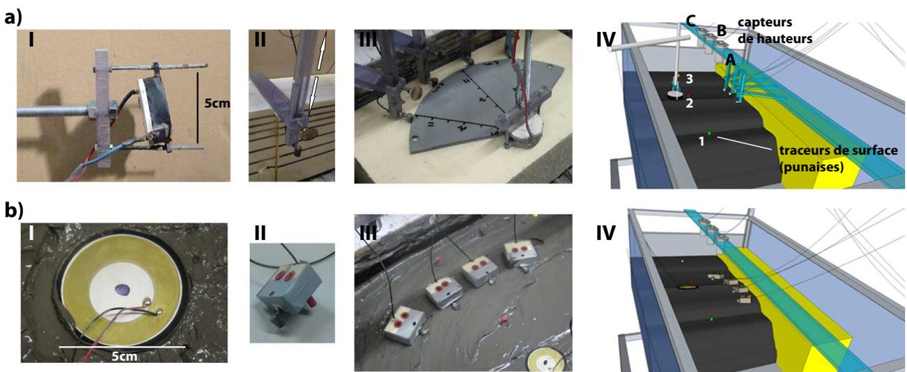
FIGURE 5.4 – Deux principaux dispositifs de mesures. a) Configuration statique, (I) source *KPE-135* sur son support, (II) accéléromètre sur son support coulissant, (III) vue de l'ensemble positionné sur la plan incliné à l'aide d'un gabarit et (IV) vue schématique d'ensemble lors des expériences. b) Configuration mobile, (I) source *KPS-100*, (II) accéléromètre fixé sur un 'flotteur', (III) vue d'ensemble installée sur le glissement et (IV) vue schématique d'ensemble lors des expériences.
