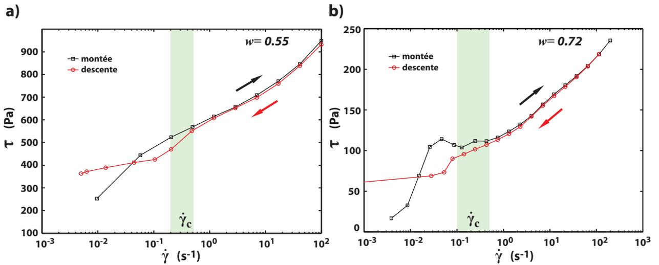
FIGURE 4.6 – Courbes d'écoulement aller-retour par rampes de taux de cisaillement pour deux teneurs en eau, a)  $w = 0,55$  et b)  $w = 0,72$ . Thixotropie marquée sous le taux de cisaillement  $10^{-1} s^{-1} < \dot{\gamma}_c < 4 \cdot 10^{-1} s^{-1}$  (délimité en vert).
