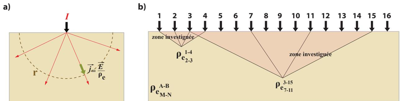
FIGURE 2.9 – a) Injection de courant  $I$  dans un demi-espace homogène et isotrope de résistivité  $\rho_e$ . b) Principe de la tomographie en configuration Wenner à 16 électrodes (A et B sont les électrodes dédiées à l’injection, M et N celles de mesure).
