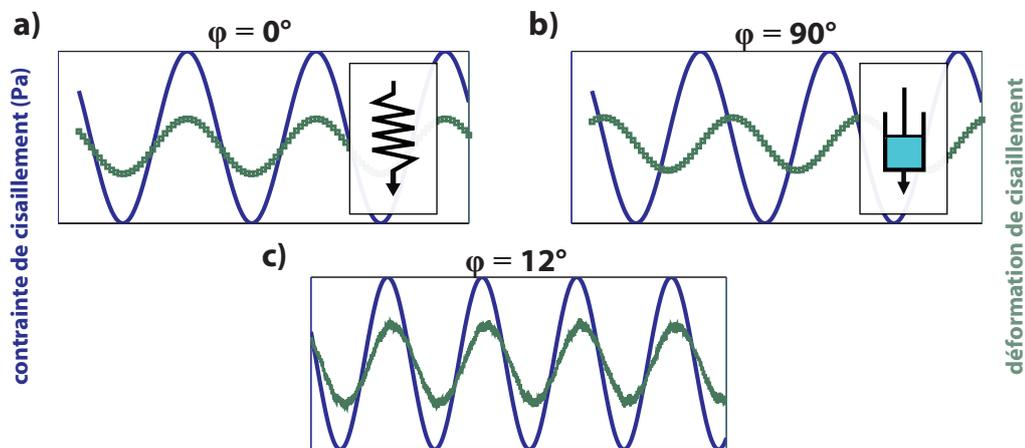
FIGURE 1.9 – Oscillation dynamique. a) La contrainte imposée (en bleu) et la déformation résultante (en vert) sont en phase ( $\varphi = 0^\circ$ ). La réponse est donc parfaitement élastique. b) Le déphasage entre la contrainte et la déformation vaut  $\varphi = 90^\circ$ , la réponse est parfaitement visqueuse. c) Exemple sur un matériau réel (argiles du Trièves), avec un déphasage de  $\varphi = 12^\circ$  montrant un comportement viscoélastique.
