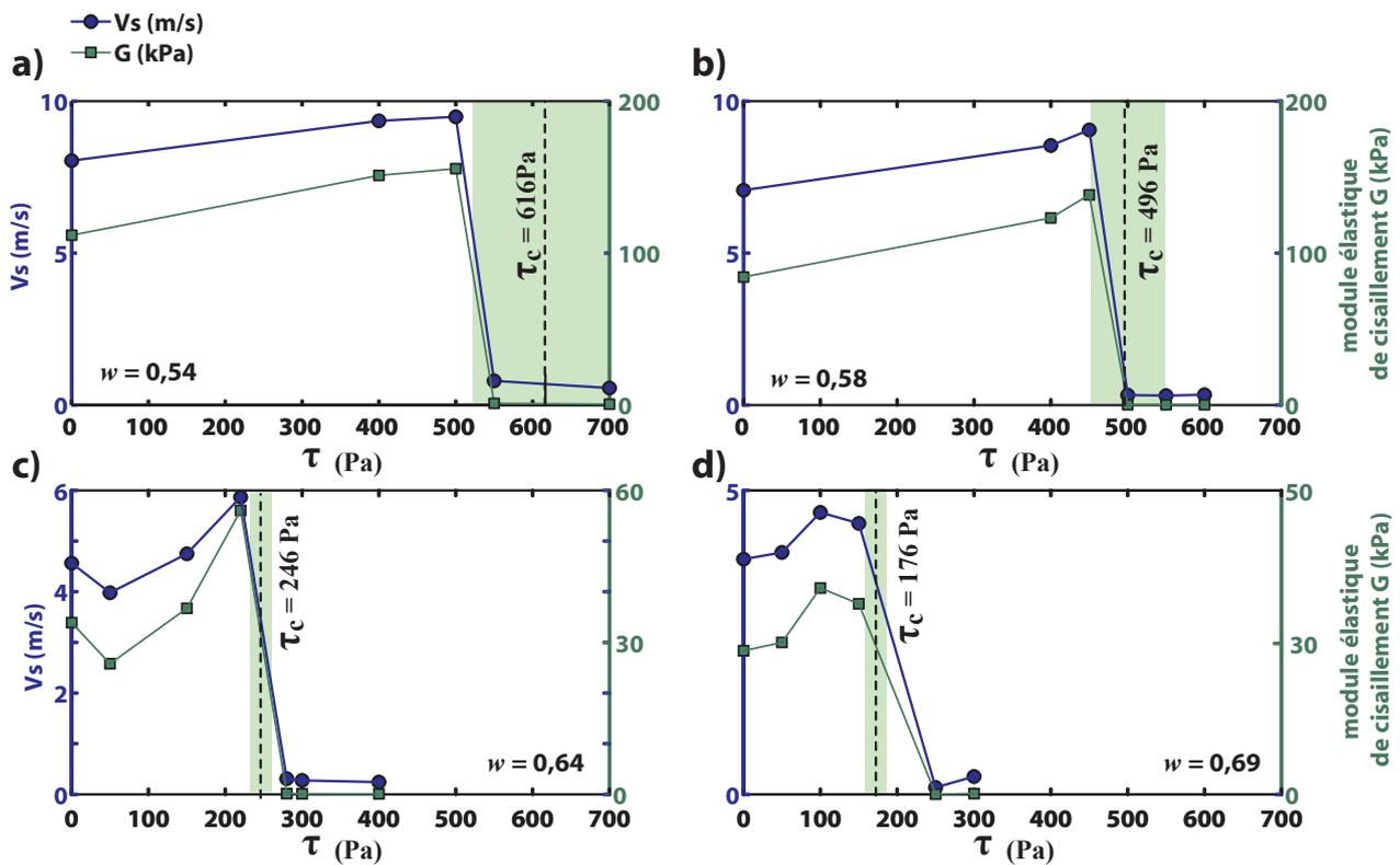
FIGURE 4.11 – Module élastique et  $V_s$  en fonction de la contrainte moyenne appliquée pour des argiles à 4 teneurs en eau différentes :  $w = 0,54, 0,58, 0,64$  et  $0,69$  (a,b,c et d respectivement). Une chute du module élastique (et de  $V_s$  correspondant) est observée pour une contrainte appliquée proche de la contrainte seuil (les incertitudes sont délimitées par les zones vert pâle).
