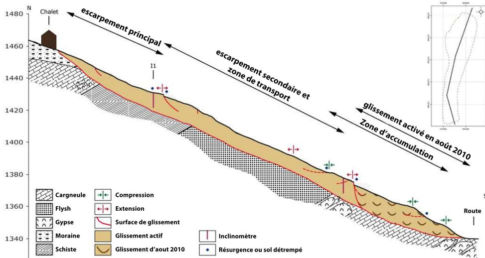
FIGURE 6.5 – Représentation du processus du glissement coulée d'août 2010 (et profil géologique et géomorphologique) (Michoud *et al.* (2010)).
