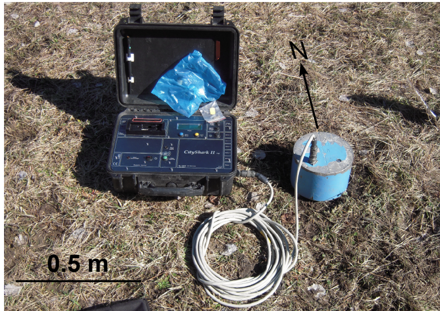
Figure 3.11 – Matériel d'enregistrement des mesures H/V. Le capteur, à droite, est placé en position horizontale grâce à un niveau à bulle et est systématiquement orienté vers le Nord.
