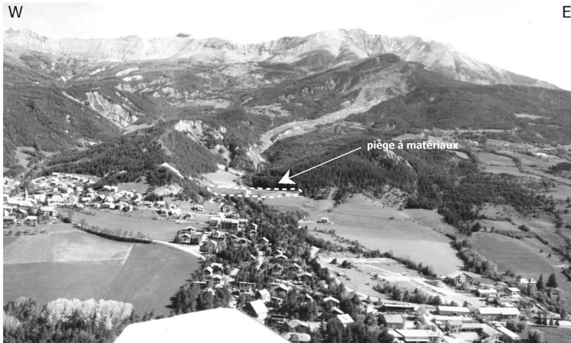
**Figure 4-17. Vue du glissement-coulée de la Valette et du piège à matériaux (mai 2002).**
