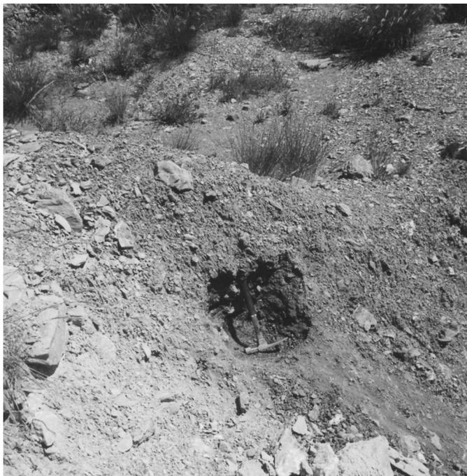
Annexe 2-6. Exemple de prélèvement d'échantillons dits intacts à la pelle mécanique et au marteau.
