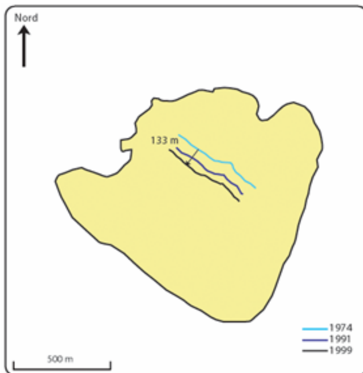
Figure 4.10: Déplacement de l'escarpement secondaire N130 du glissement de la Clapière, mesuré sur les cartes de convexité des pentes.
