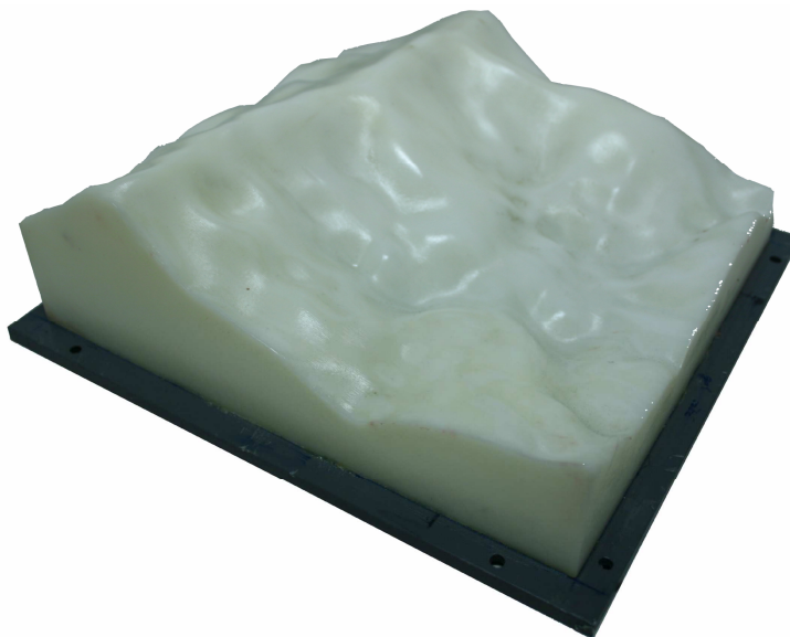
Figure 2-9 : Photo d'un contre-moule de 22 cm x 20 cm et servant à la réalisation de modèles en trois dimensions basés sur des topographies réalistes. C'est ici une portion de la Matter Valley centrée sur la falaise du Grossgufer.
